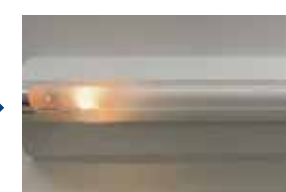
LEDソケットに蛍光管を取り付けると管はショートするが発火も発煙もしない
